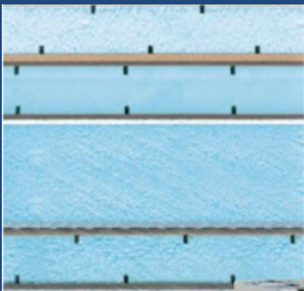
Bei handelsüblichen Schaumkernen wird eine Behandlung der Oberflächen empfohlen, um die Sekundäranbindung zu verbessern. Die empfohlenen Rillen von 2x3 mm alle 50mm auf einer Länge von 1000mm führen zu einer bemerkenswerten Harzaufnahme im Bauteil.
