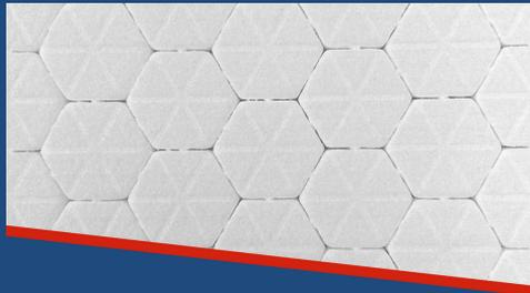
Der 3D|CORE™ PET FR Schaumkern ist ein geschlossenzelliger, thermoplastischer und recycelbarer Hochleistungskern mit hervorragenden feuerhemmenden, selbstverlöschenden Eigenschaften gemäß DIN EN 45545-2 und IMO 2010 FTP Code Part 5. Die integrierte Wabenstruktur bietet mehr Flexibilität und vereinfacht die Handhabung in der Produktion. Der Schaumkern kann mit allen bekannten Harzsystemen und Prozessen verarbeitet werden.
